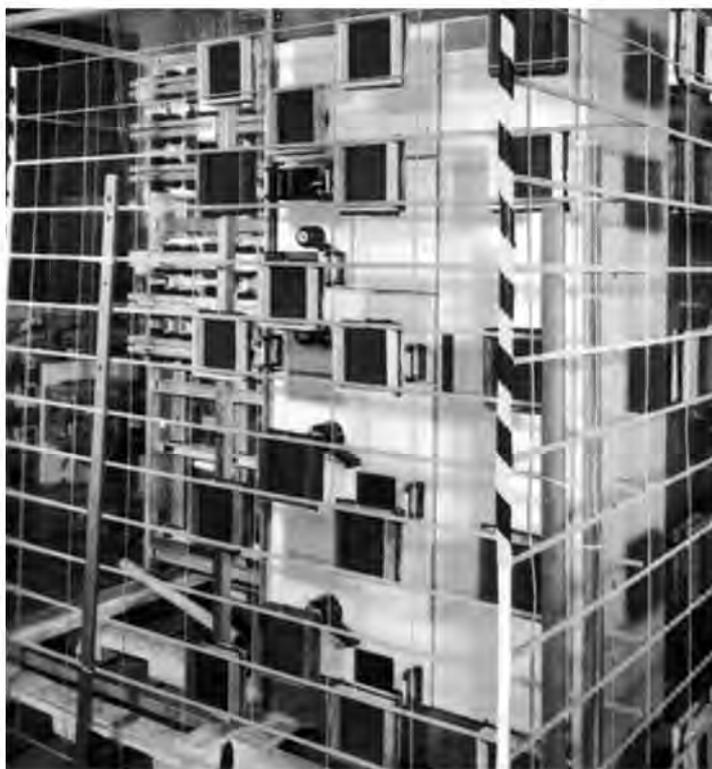
Figure 12.23 – Tableau en cours avant un essai à l'arc interne (Moeller Electric).
