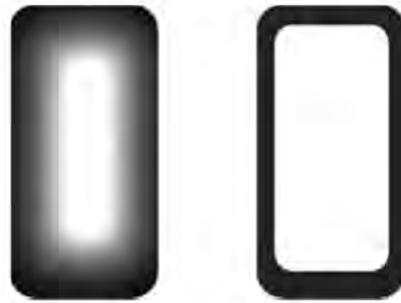
**Figure 12.13** – Répartition du courant dans un conducteur plein de forte section.
