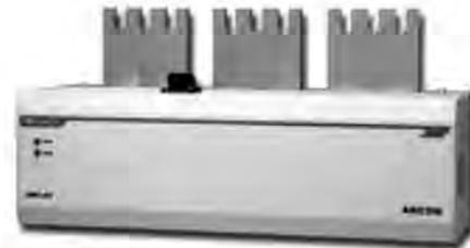
En cas de réponse de l'unité d'analyse électronique, tout se déroule à la vitesse de l'éclair. ARCON® éteint l'arc en 2 ms, avant que ce dernier n'ait eu le temps de causer des dégâts sérieux dans l'installation.
