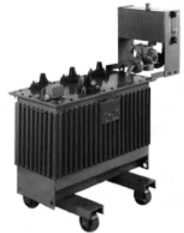
fig. 1 : une bobine zigzag ou bobine de point neutre, constitue une réactance de limitation des courants de défaut terre.
