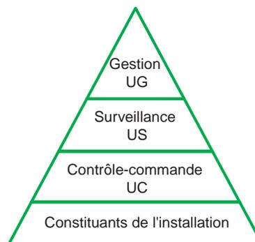
**Fig. 10** : niveaux hiérarchiques de la gestion technique de l'électricité.
