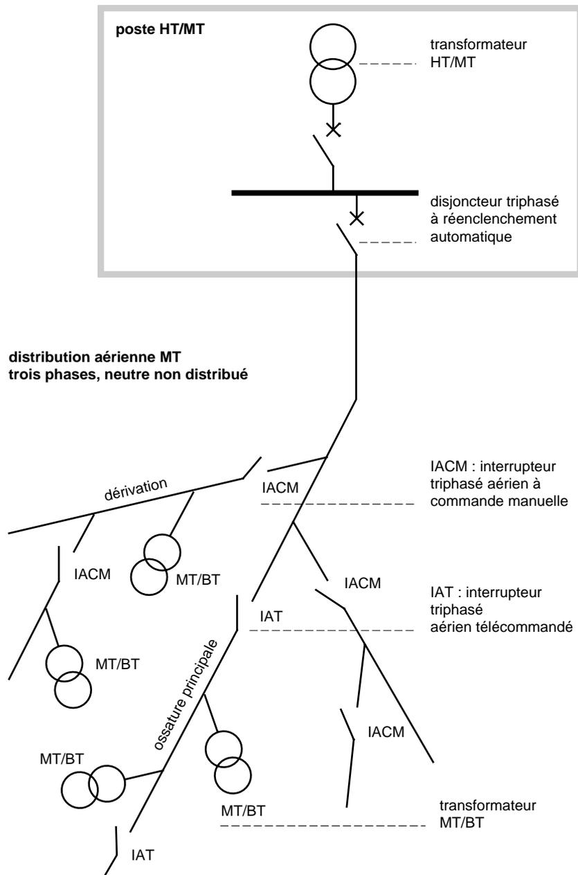
fig. 20 : schéma de distribution aérienne MT (EDF - France).
