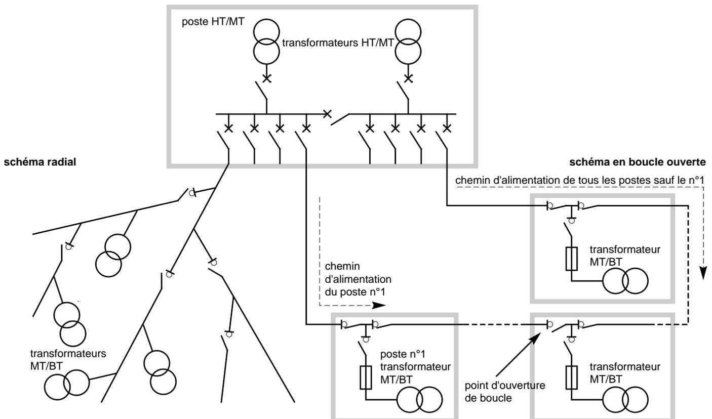
fig. 9 : les deux schémas de base d'un réseau de distribution MT, radial (ou en antenne) et en boucle ouverte (ou coupure d'artère).
