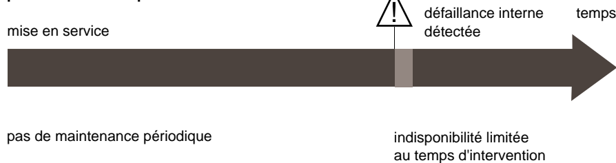
fig. 12 : l'auto-surveillance permet de réduire le temps d'indisponibilité de la protection donc augmente la sûreté de l'installation électrique.
