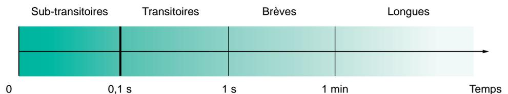
fig. 1 : perturbations de tension dans les réseaux.
