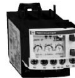
Fig. 29 : le relais de surcouple (LR97D - Telemecanique) est une protection complémentaire en cas de blocage du rotor, de grippage ou d'à-coups mécaniques.
