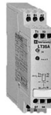
Fig. 28 : dispositif électronique (LT3 - Telemecanique) à associer à trois sondes à thermistance, pour commander l'arrêt d'un moteur en dépassement de température.
