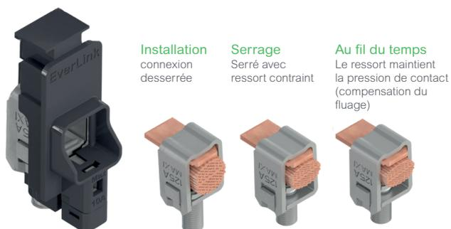
Figure 1.7. Technologie brevetée EverLink
